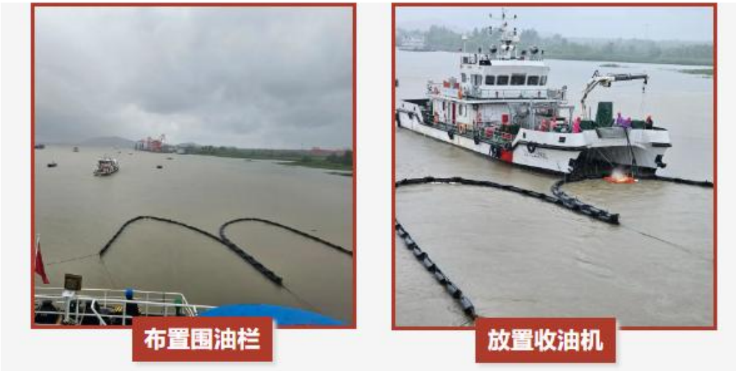
图 6.7-4 武汉监管救助综合基地布置围油栏、放置收油机现场图
